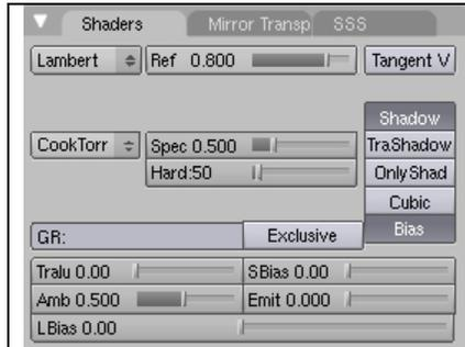
**Shaders** (Ombreggiatori): con questo pannello è possibile regolare l'intensità dei fenomeni di diffusione e specularità del materiale, utilizzando i primi due slider. Lo slider "Ref" serve per impostare la quantità di energia di luce diffusa, mentre lo slider "Spec" imposta la quantità di energia riflessa specularmente.
