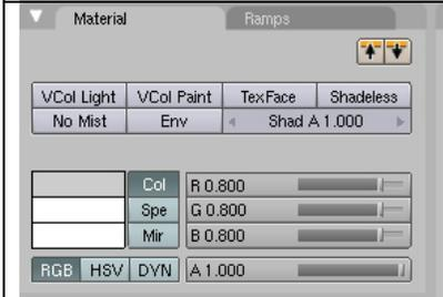
Il pannello successivo mi permette di determinare il colore (valori RGB) e la trasparenza dell'immagine. Se premo il tasto Spe mi permette di determinare il colore speculare del materiale, mentre Mir il colore di riflesso. A (Alfa) sotto RGB mi indica il grado di trasparenza del materiale se ho premuto il tasto zTransp nella schera precedente.
